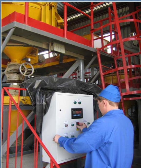
Пульт управления узла цементирования ЖРО, содержащих минеральные масла и/или органические жидкости
