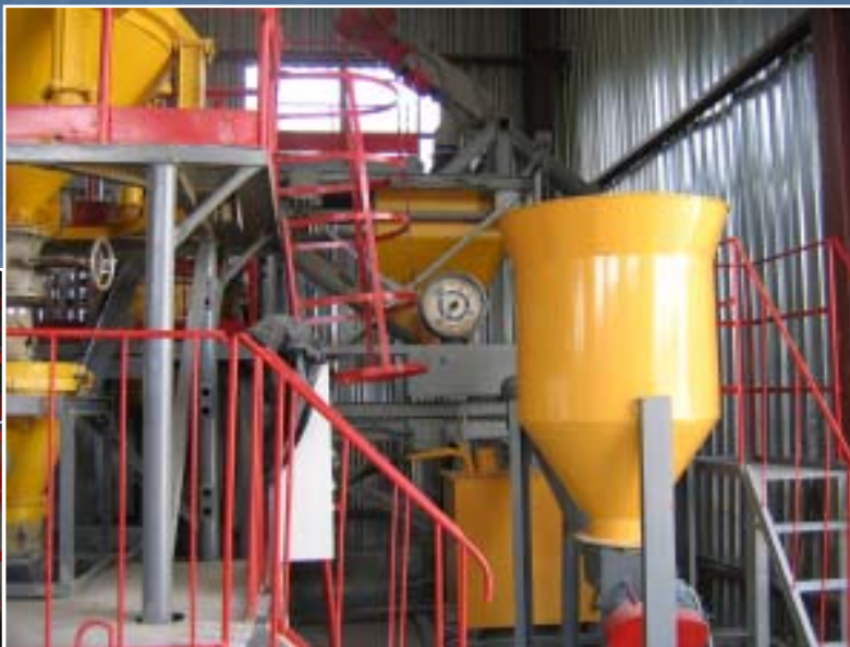
Узел для цементирования ЖРО, содержащих минеральные масла и/или органические жидкости
