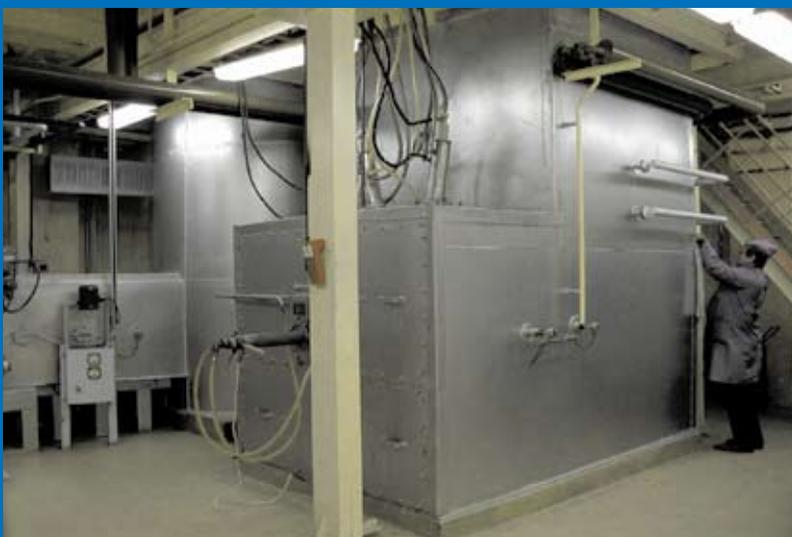
Опытно-промышленная установка плазменной переработки радиоактивных отходов «Плутон»
