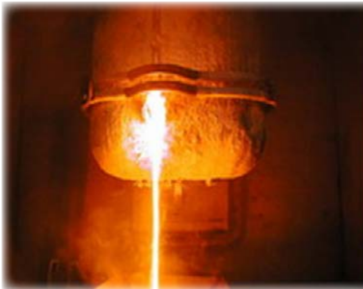
Установка остекловывания РАО
