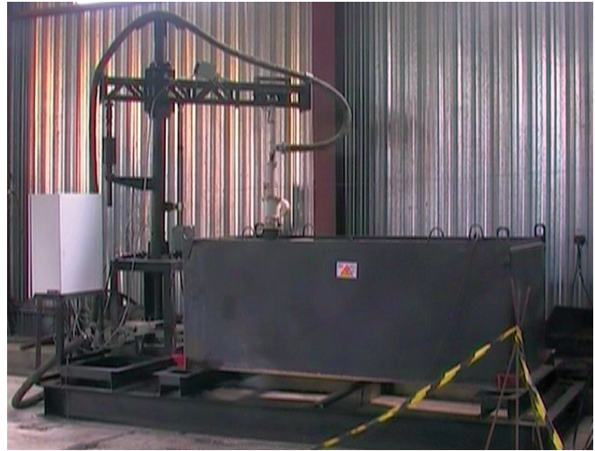
Рис. 12. Установка цементирования ТРО методом пропитки в контейнерах КРАД / Fig. 12. Plant for solid radwaste cementation by impregnation in KRAD containers
