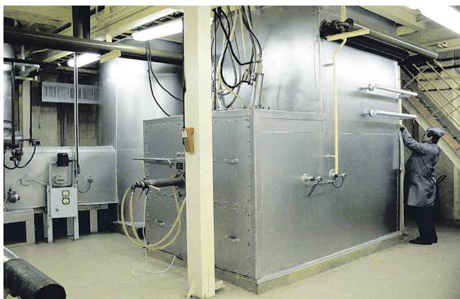
Рис. 10. Установка плазменно-пиролитической переработки РАО «Плутон» / Fig. 10. Pluton plant for plasma-pyrolysis processing of radwaste
