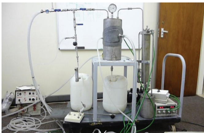
Рис. 16. Мобильная установка проточной электрохимической дезактивации с вакуумируемым электродным устройством / Fig. 16. Mobile flow-through electrochemical decontamination plant with vacuuming electrode assembly
