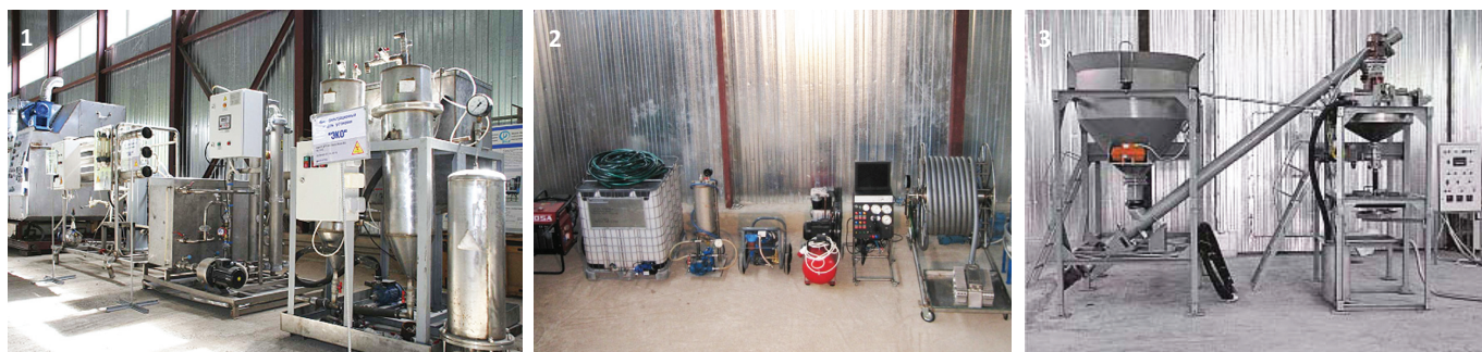
Рис. 2. Модульная установка «Эко» (1) с модулем забора донных осадков из емкостей-хранилищ жидких РАО (2) и модулем цементирования (3) / Fig. 2. Modular Eco plant (1) with a sludge intake module from liquid radwaste storage tanks (2) and cementation module (3)
