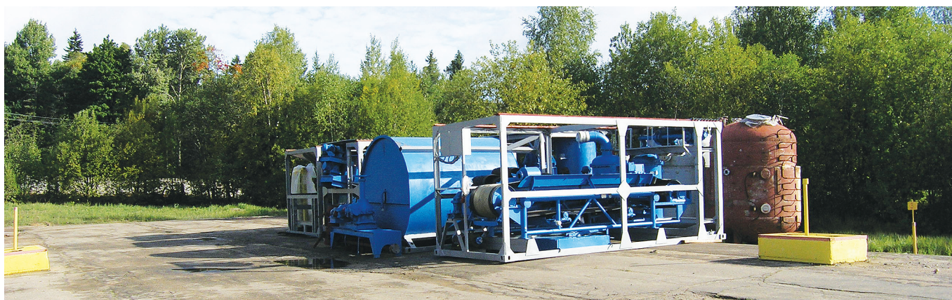
Рис. 15. Установка гидросепарационной очистки грунта / Fig. 15. Soil hydraulic separation treatment plant
