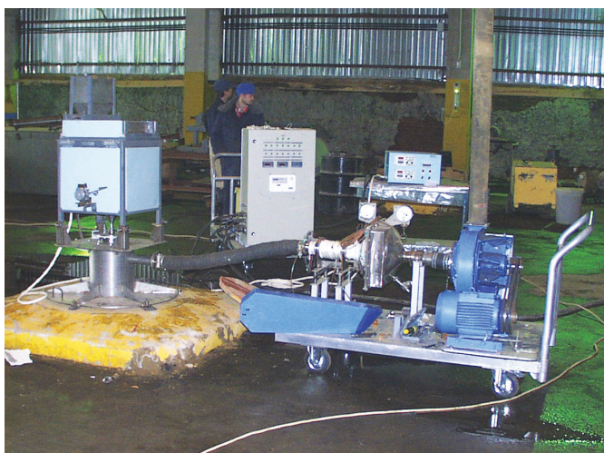
Рис. 7. Установки «МИК-1», «Москит-Т» для кондиционирования отработавших РНИ Fig. 7. MIK-1 and Moskit-T plants for used sources conditioning
