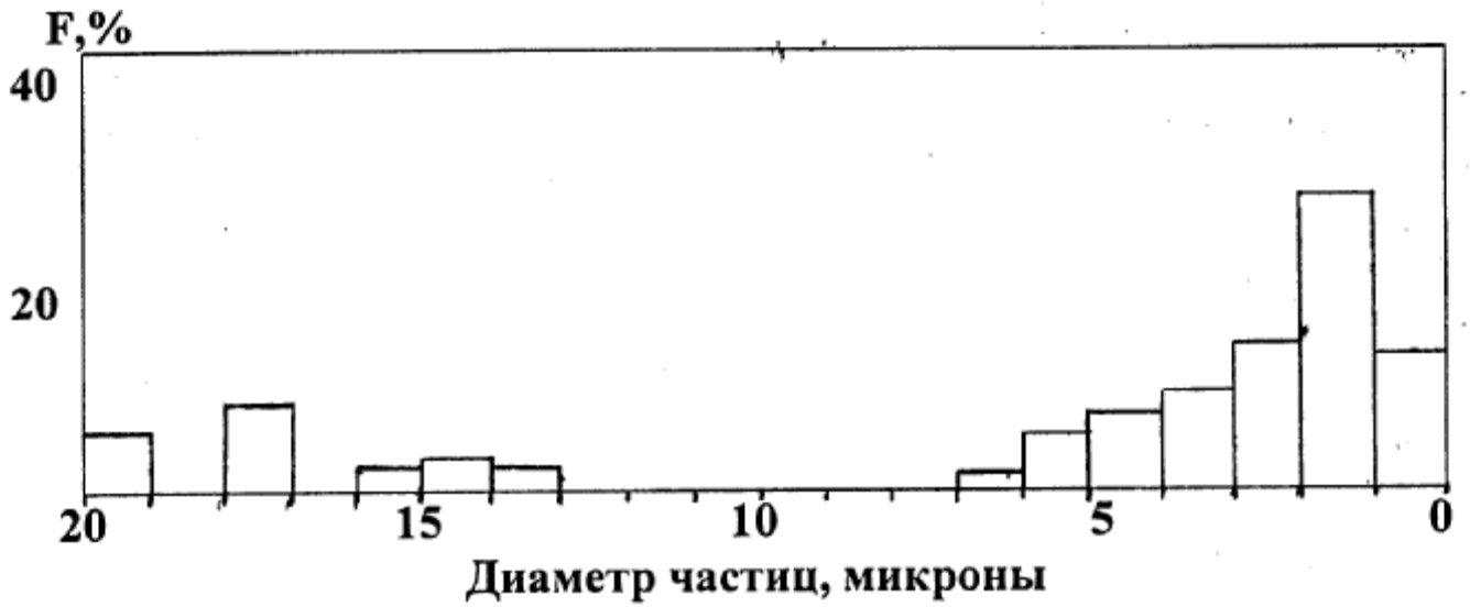
Рисунок 29 – Гранулометрический состав первичного порошка тантала, удельная поверхность – 9,2 \text{ м}^2/\text{г}
