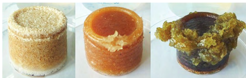
Рис. 3 Вид разрушений полимерных матриц
