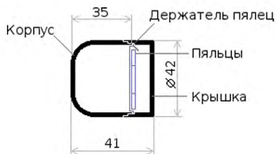
Рис.1 Схема радионового экспозиметра РЭИ-4
