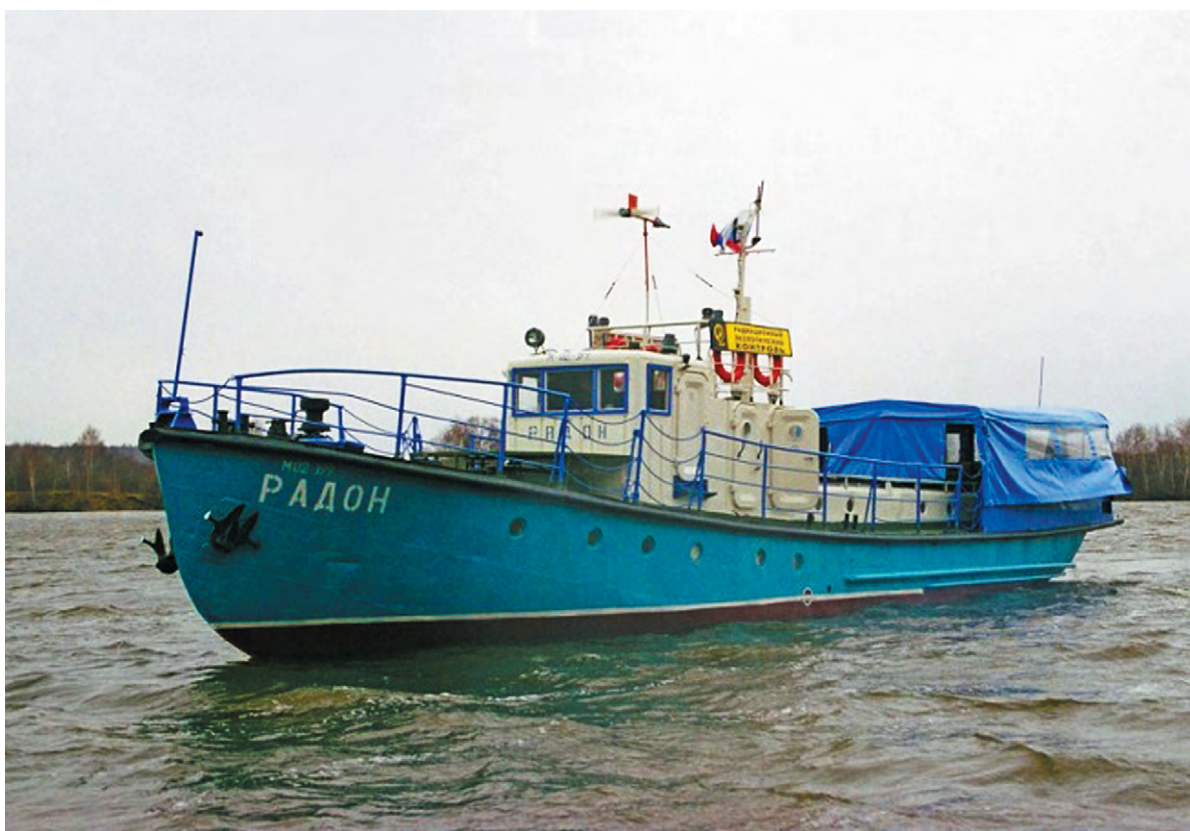
Рис. 3 Мобильный водный комплекс радиационного контроля
