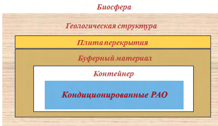
Рис 1 Схематическое изображение многобарьерной системы изоляции РАО
