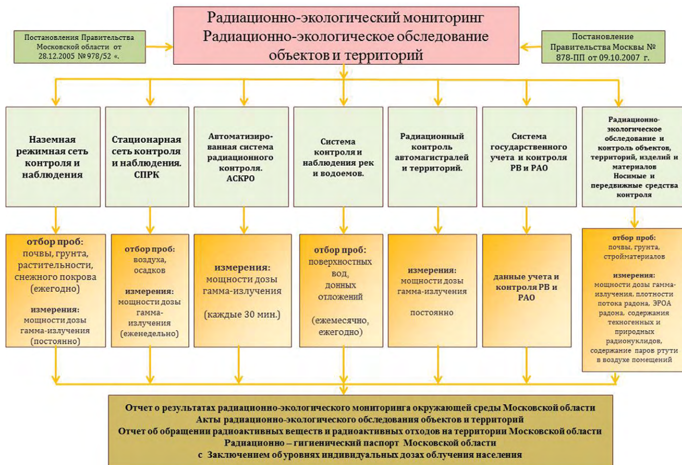
Рис.1 Комплексная система контроля радиационной обстановки
