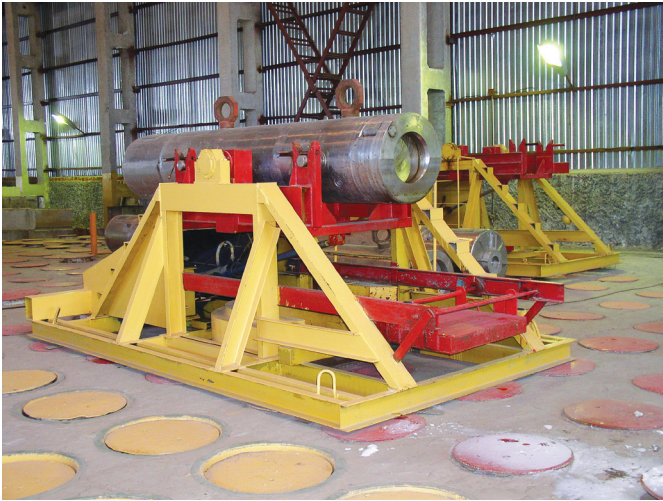
Кантователь реакторных пеналов ГУП МосНПО «Радон» SNF casing manipulator at Radon Moscow
