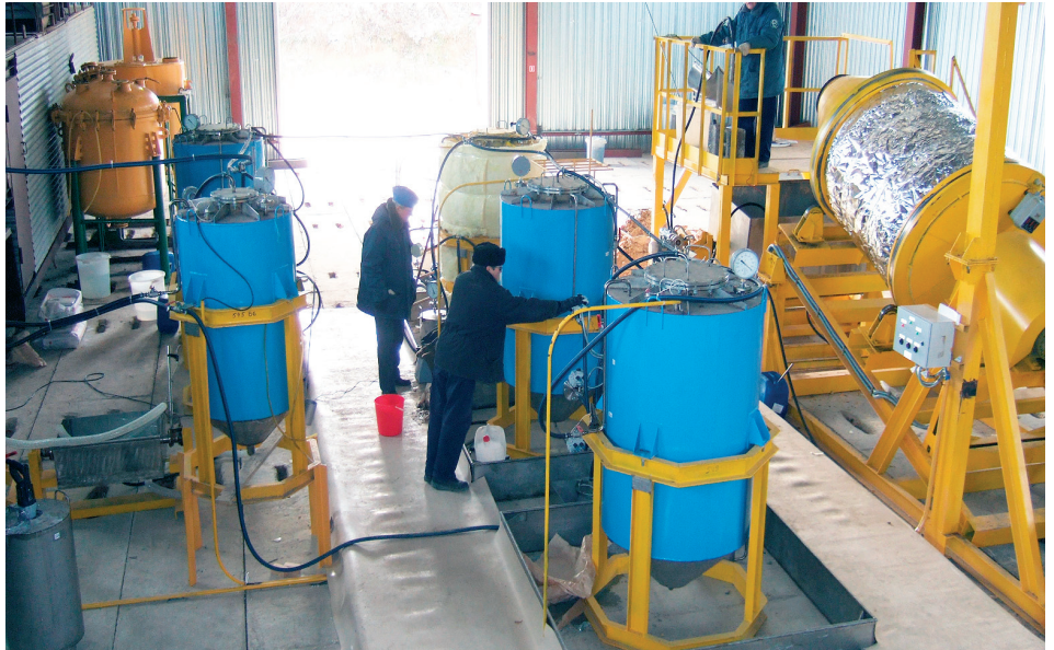
Рис. 1. Испытания на опытной установке дезактивации грунтов с вращающимся реактором-смесителем / Fig. 1. Tests on a pilot soil decontamination plant fitted with a rotating reactor-mixer
