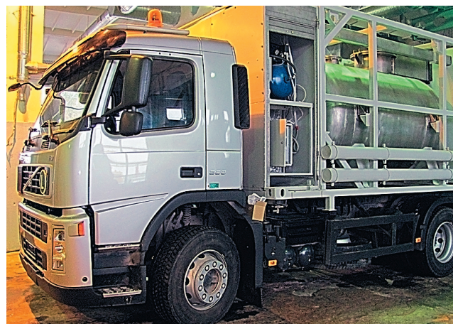
Спецавтомобиль для транспортирования ЖРО Special truck for liquid radwaste
