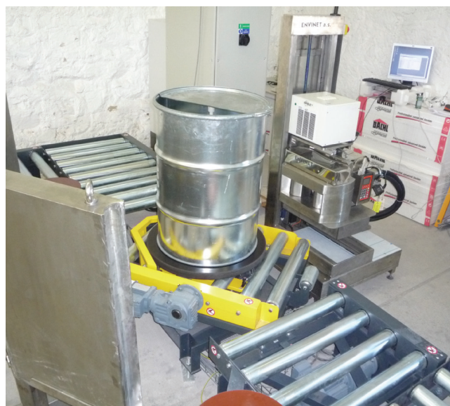
Рис. 3. Стационарный \gamma -спектрометр ENV.GMS-08.01s (перестраиваемый коллиматор, система электроохлаждения (X-cooler), конвейер емкостью 21 упаковка, встроенные весы, платформа вращения) Fig. 3. Stationary \gamma -spectrometer ENV.GMS-08.01s (tunable collimator, electrical cooling system (X-cooler), 21-package capacity conveyor, built-in scales, turntable)
