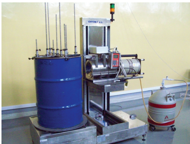
Рис. 2. Мобильный \gamma -спектрометр ENV.GMS-08.01m для измерений РАО в 200-литровых металлических бочках, оборудован платформой вращения
