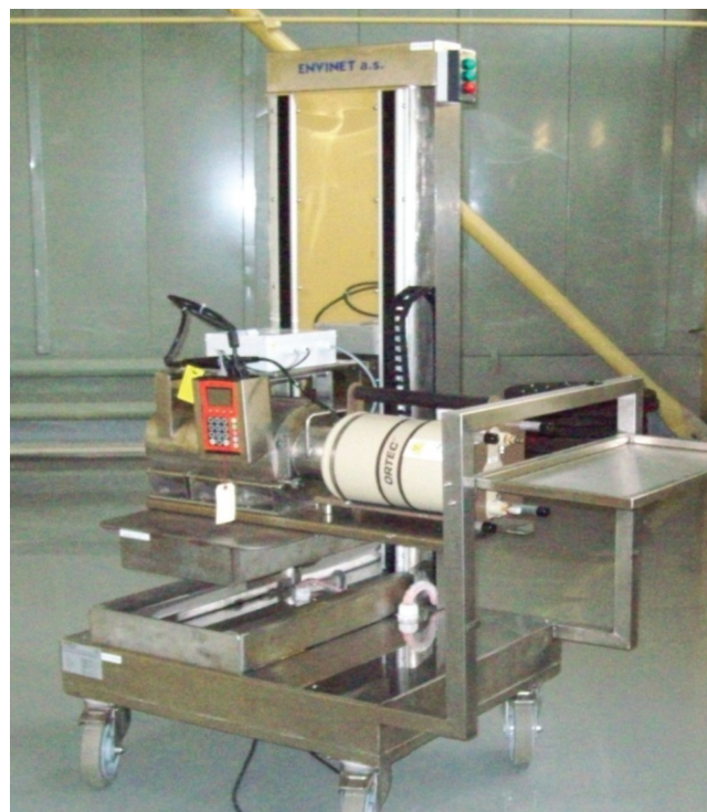
Рис. 1. Мобильный \gamma -спектрометр ENV.GMS-08.02 для измерений упаковок большого объема, имеющих форму параллелепипеда Fig. 1. Mobile \gamma -spectrometer ENV.GMS-08.02 for measurements on large parallelepiped-shaped packages
