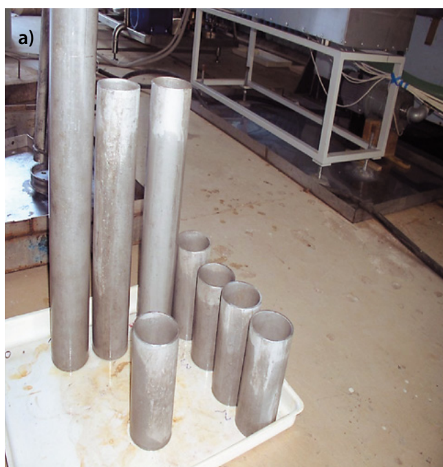
Рис. 3. Трубы (а) и фрагмент чехла ОТВС (б) после дезактивации Fig. 3. Tubes (a) and fragment of SFA container bundle (b) after decontamination
