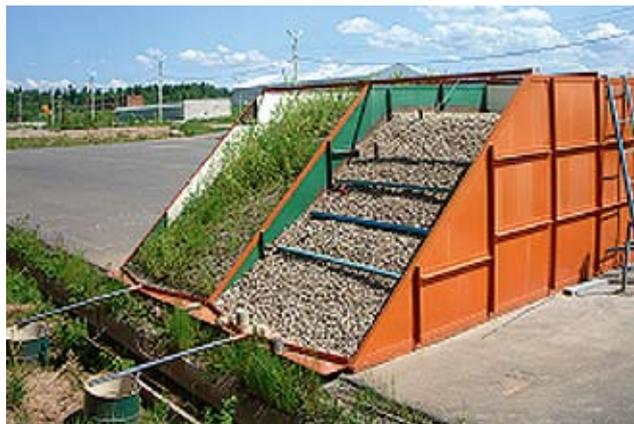
Опытные стенды для исследования материалов и определению необходимых параметров (количества, состава и толщины слоев) многофункциональных защитных покрытий хранилищ РАО
