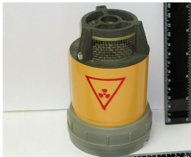
Радиационный извещатель дыма РИД-1 A radiological smoke detector RID-1
