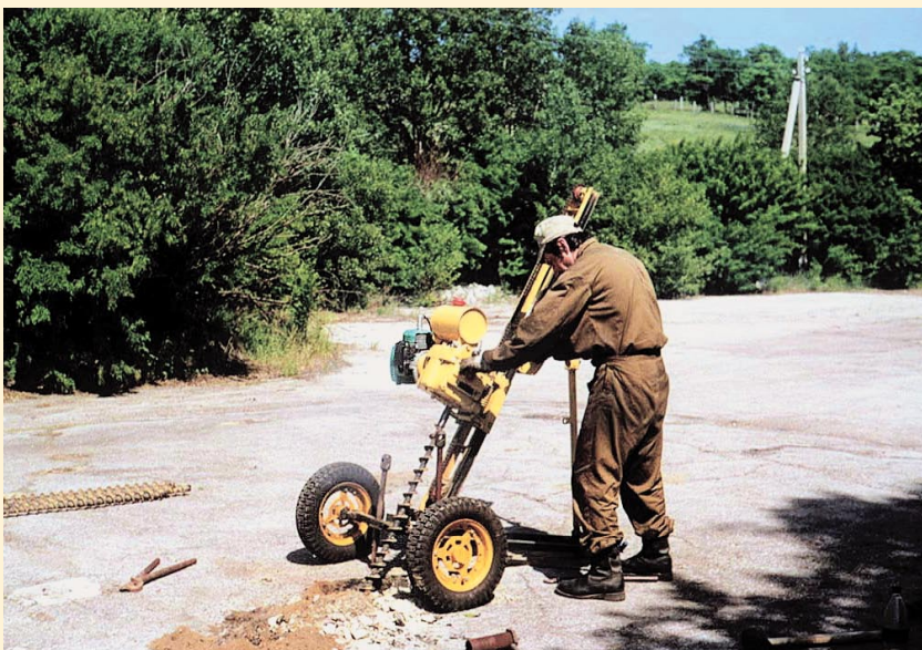
△ Бурение геомониторинговых скважин на территории Саратовского СК «Радон»
