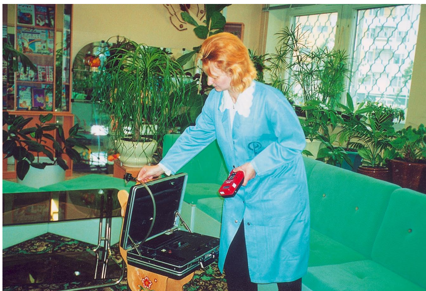
△ Замер содержания газа радона в воздухе помещения одного из детских садов Москвы
