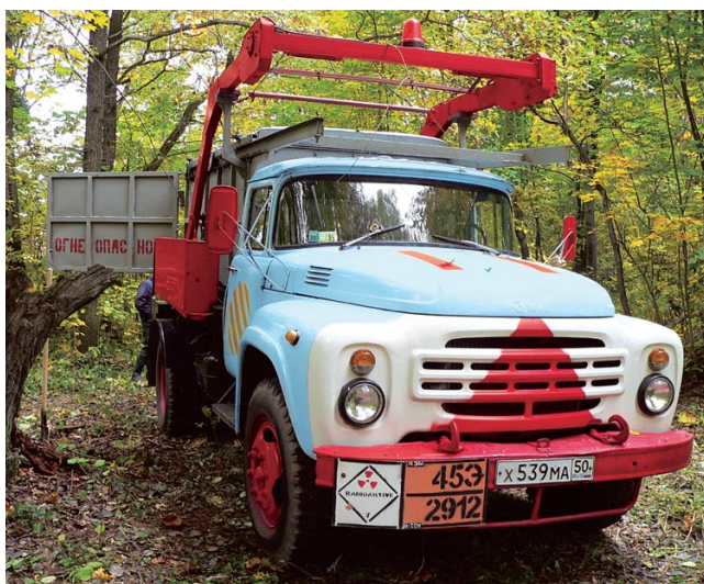
△ Машины для ТРО и ИИИ оборудованы прочным закрытым стальным самосвальным кузовом
