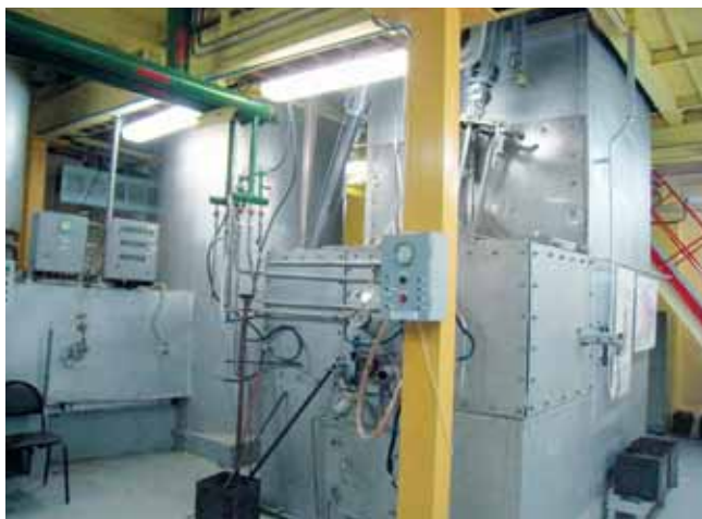
Печь установки «Плутон»: нижняя часть шахты – плавильная камера Pluton plant furnace: the lower section of the shaft, which is the smelter
