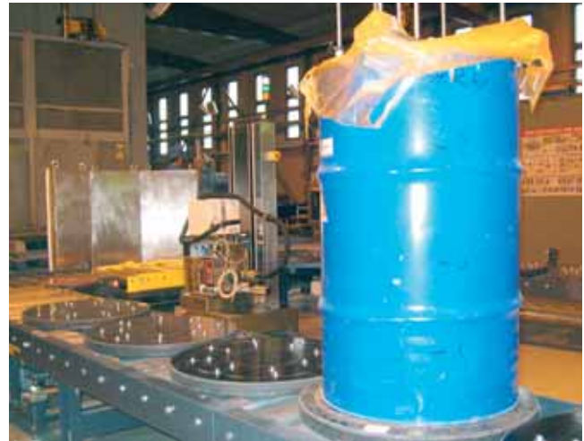
Упаковка РАО на конвейере \gamma -спектрометрической установки A package of radwaste on the \gamma -spectrometry conveyor
