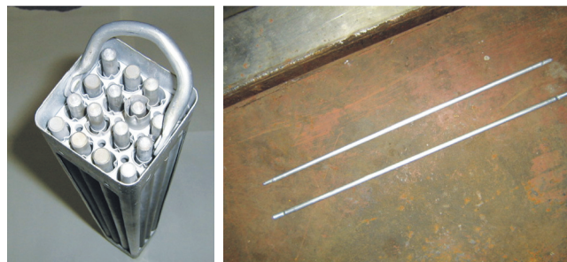
Рис. 1. Тепловыделяющая сборка (сечение 68×68 мм, длина 700 мм, масса около 3,5 кг) и отдельные твэлы реактора ВВР-2
