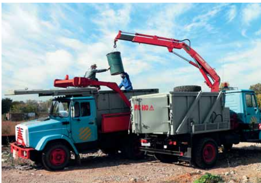
Погрузка контейнеров с РАО на спецтранспорт Loading of radwaste containers
