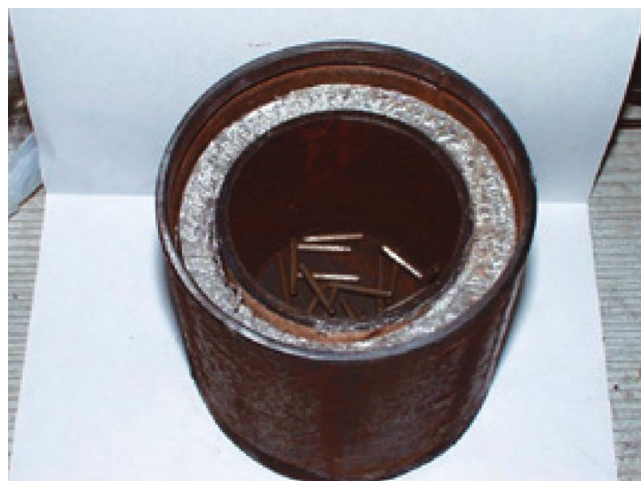
Герметичная металлическая капсула для ИИИ с долгоживущими \alpha -излучателями A sealed metallic capsule for SIRs that contain long-lived \alpha -emitters
